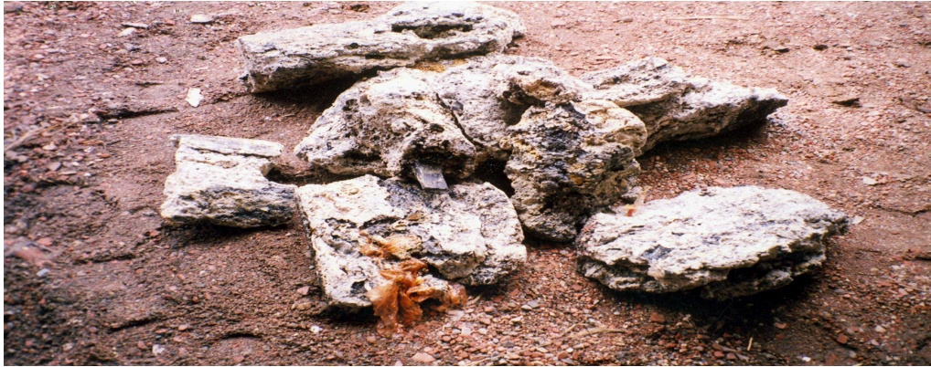
Şekil 5.9 Taşlaşmış Atık Yağlar
