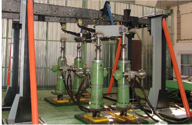
Şekil 7.23 Dingilin Laboratuvar Ortamında Hızlandırılmış Ömür Testi
