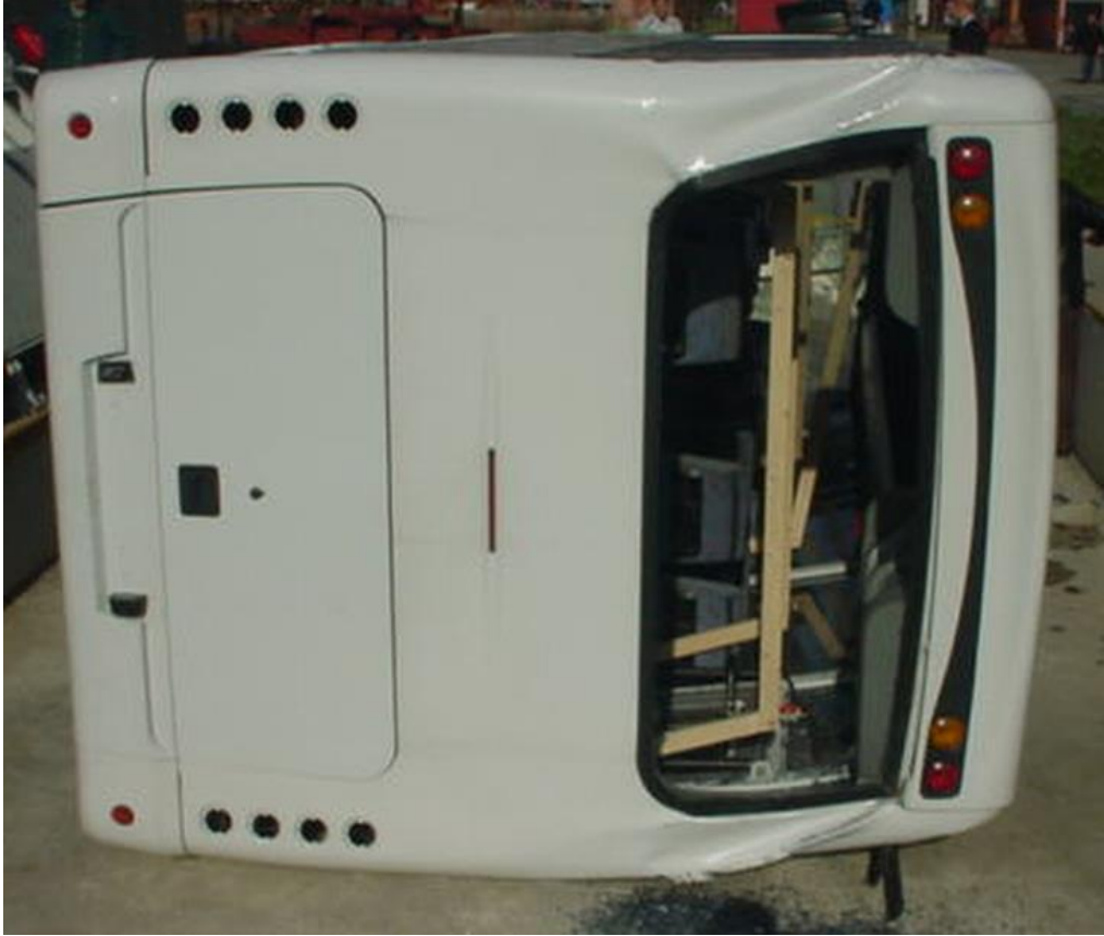
Şekil 5.7: ECE R66 testi sonucu (tavan profili)
