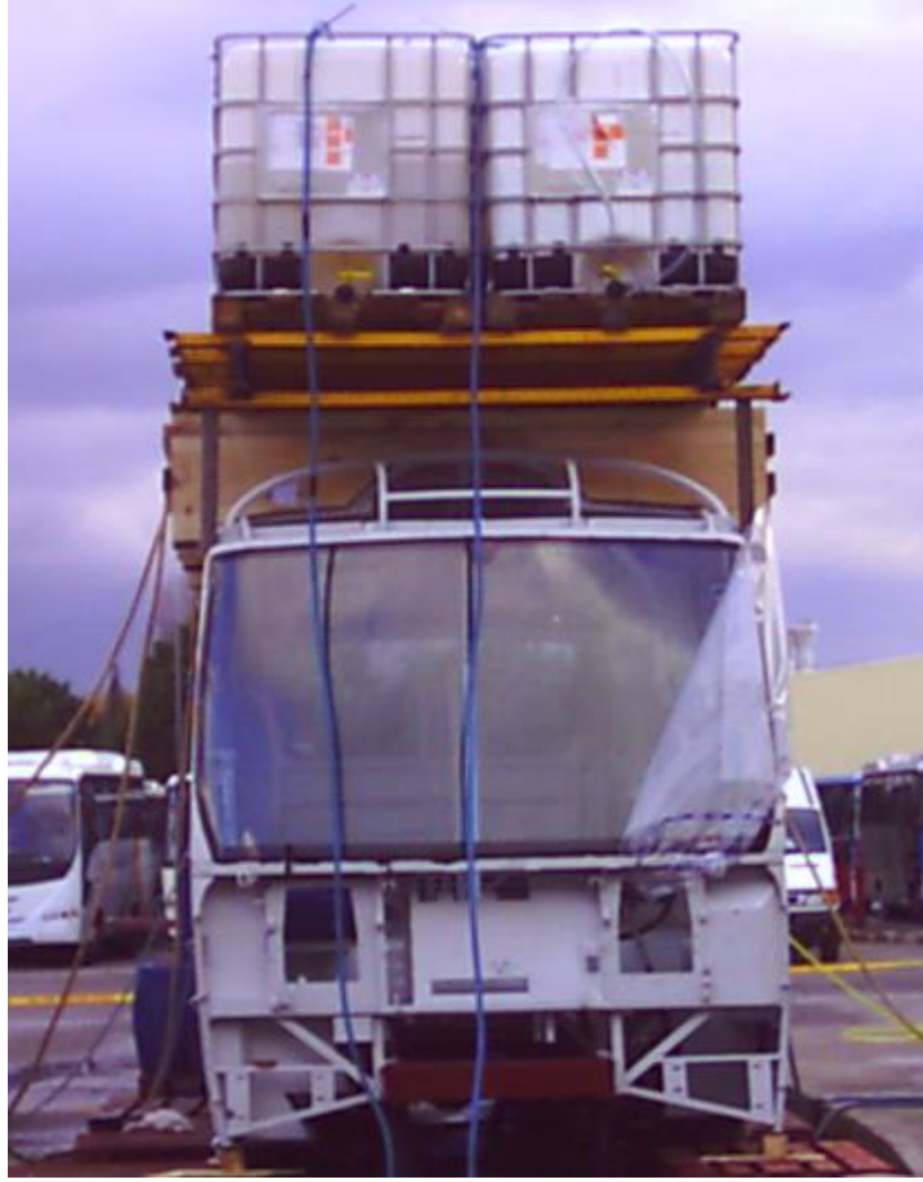
Şekil 5.1: Eurobus Tector için tavan çökme testi
