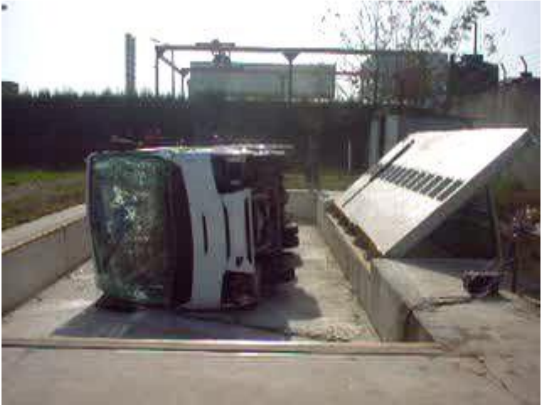
Şekil 5.4: ECE R66 testi ile devrilmiş araç
