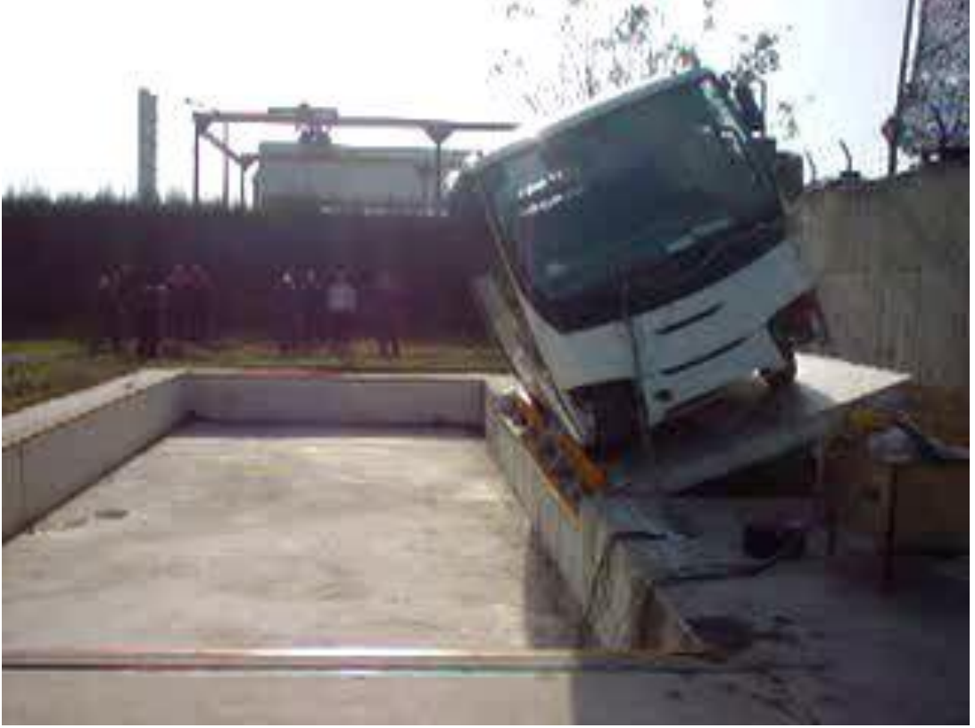
Şekil 5.3: ECE R66 test standı
