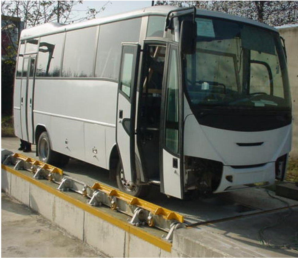
Şekil 2.6: Eurobus Tector için Otoyol'un ECE R66 test standı
