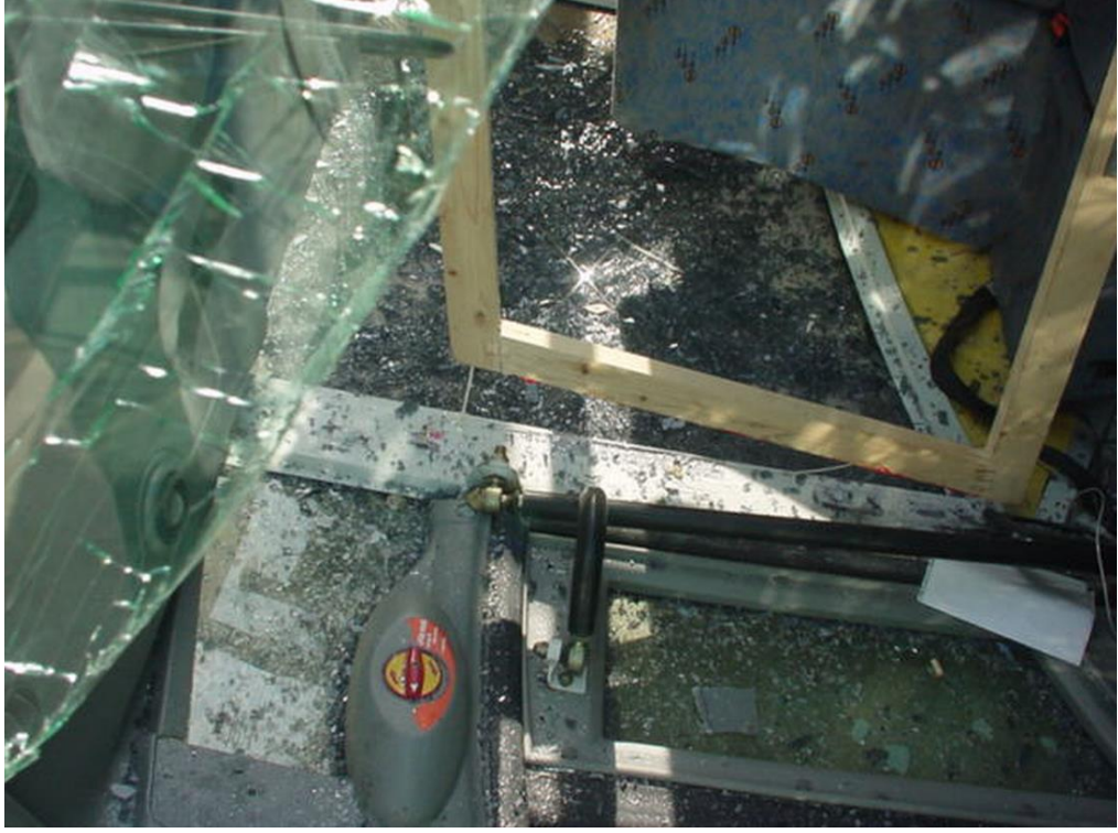
Şekil 5.6: ECE R66 testi sonucu (yan profiller)
