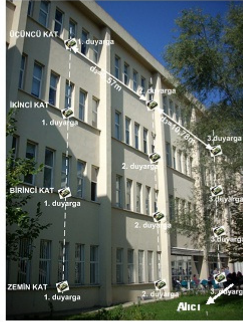
Şekil 7.13 : Bina-2 üzerinde çoklu duyarga okuma testleri sırasında duyargaların bina üzerine yerleşimi ve alıcı ile gönderici arasındaki uzaklıkların temsili gösterimi ( d_{ij} : göndericinin bulunduğu kata göre alıcı ile arasındaki uzaklık, i : etiket numarası, j : kat numarası) (Sensenode v.2.1 için).
