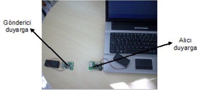
Şekil 7.6 : Alıcı duyarga ve gönderici duyarga arasındaki açı 0 (pozisyon no 2).
