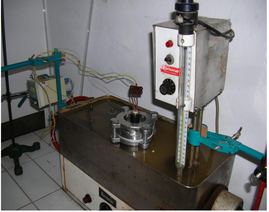
Şekil 3.1 : Doğrudan Isıtma Yöntemi ile Kaplama Hazırlama Düzeneği
