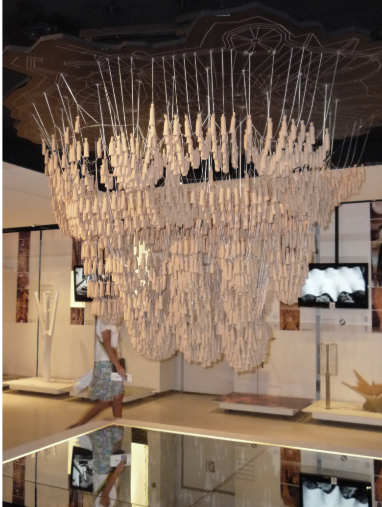
řekil 3.2 : Sagrada Familia Kilisesi'nin asılı zincir maketi, Antoni Gaudi, 1882, Strüktürel hesaplamaları yapabilmek için Gaudi'nin geliřtirdiđi teknik, (Url-8).
