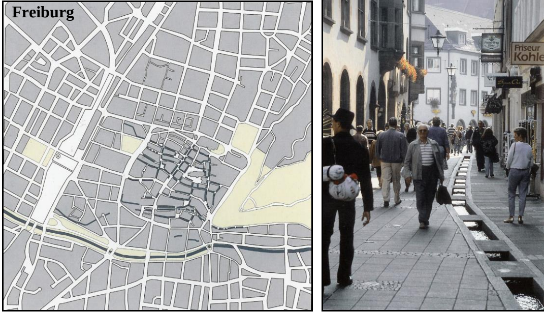
Şekil 3.4.: a- Freiburg Şehir merkezi. Koyu renkli çizgiler Freiburg'un kamu alanlarında tekrarlanan mimari temayı oluşturan küçük su kanalları, 'backle' sistemini gösteriyor. b- Drenaj görevi de gören küçük su kanallarının sokak mekandaki görünümü (Gehl ve Gemzøe, 2001).
