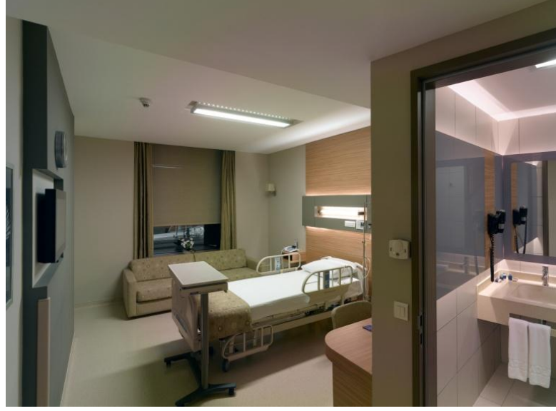
Şekil 5.2 : Hasta odasında hasta kontrolünde armatürler ve termostat. Hasta veya yakını, hasta odasındaki tüm aydınlatma armatürlerini hem odanın girişinden hem de hasta başındaki anahtarlardan kontrol edebilir. oda girişindeki termostat ile de her odanın sıcaklığı ayarlanabilir. Acıbadem Adana Hastanesi, (Zoom TPU arşivi, 2009)
