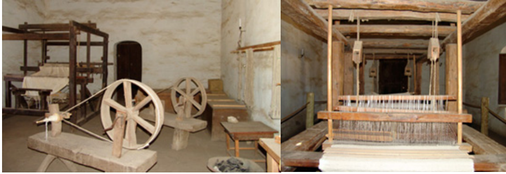
Şekil 4.9 : Basit çıkırıktır ve dokuma tezgahı (Url-4).
