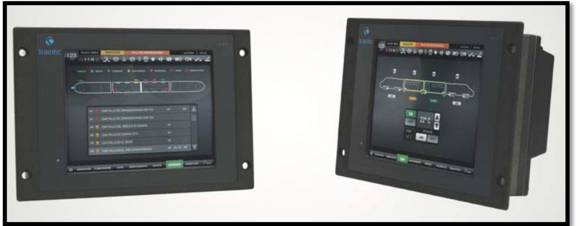
Şekil 3-5 : COSMOS sisteminin insan-makine arayüzünü sağlayan modül.
