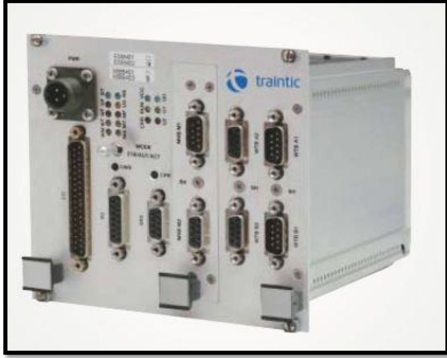
Şekil 3-7 : COSMOS sisteminin ağ geçidi modülü.
