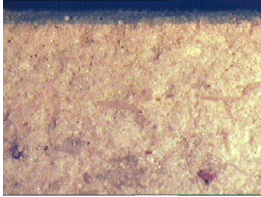
Şekil 5.5 : İnce astarlı, kil+kuvars bünyeli TOP N606 çinisinin kesit makro yapısı.
