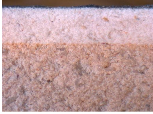
Şekil 5.4 : Kalın astarlı, kil+kuvars bünyeli TOP A1 çinisinin kesit makro yapısı.
