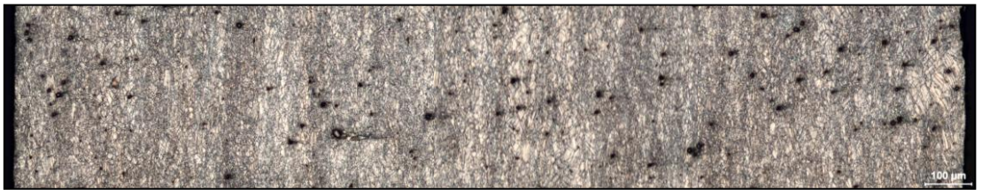
Şekil 6.4 : DSD AZ31 levhanın boy kesitinin ışık mikroskobu görüntüsü.
