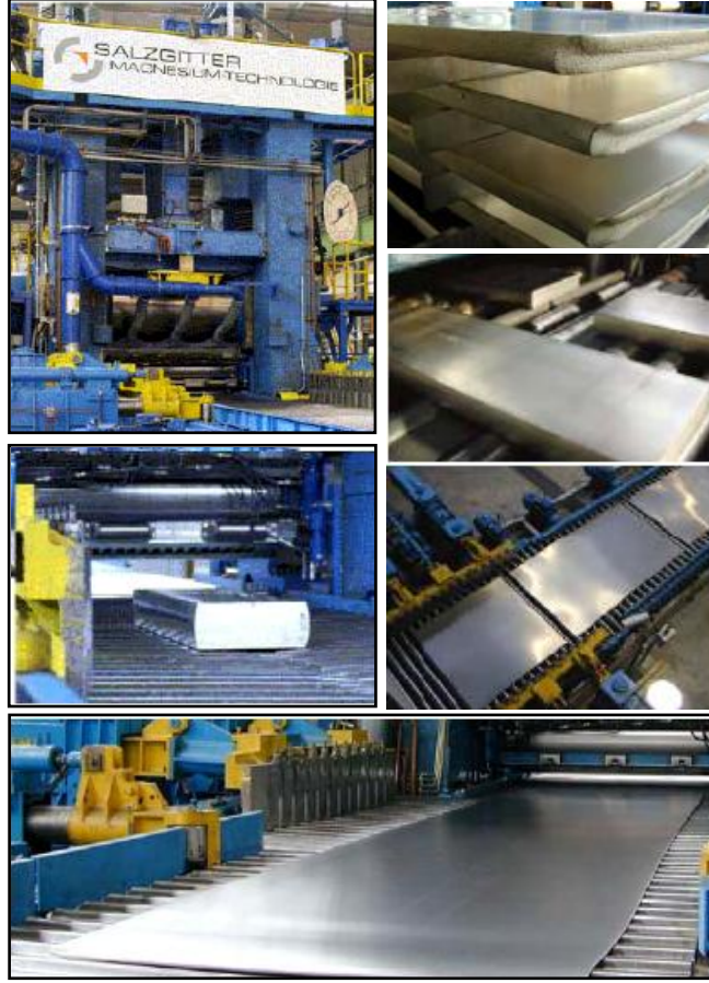
Şekil 3.1: Salzgitter firmasında DSD yöntemi ile üretilen plakalar ve haddeleme işlemi sonrasında elde edilen magnezyum levhalar [17,42].
