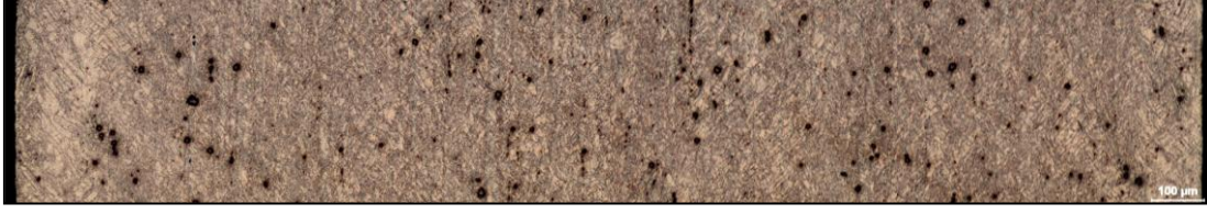
Şekil 6.5 : DSD AZ31 levhanın en kesitinin ışık mikroskobu görüntüsü.
