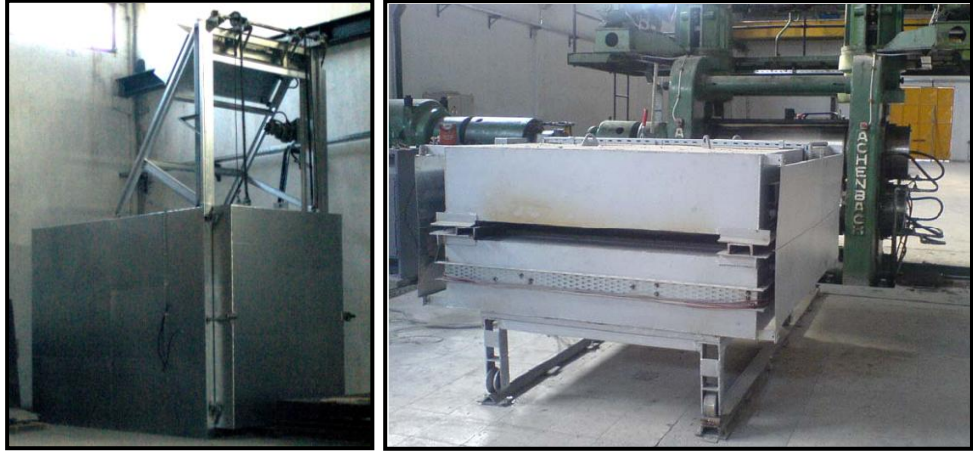
Şekil 3.6: Endüstriyel ölçekli ısıtma fırını, sıcak haddeleme için kullanılan fırın ve merdaneler [71,72].
