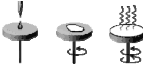
Şekil 2.17: Döndürerek kaplama prosesi kademeleri [109].
