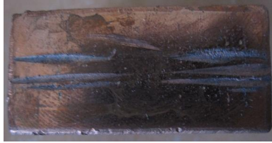
Şekil 2.1 : Bakır elektrot üzerinde meydana gelen aşınma örneği
