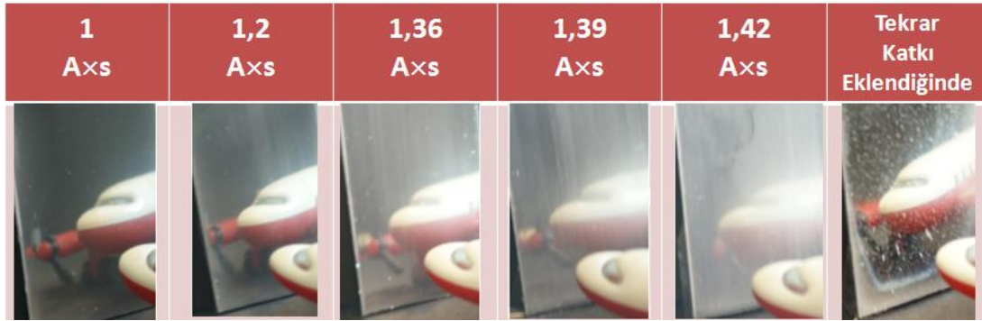
řekil 8.29: 2-Mercaptobenzothiazole (2 g/L) + KSeCN (3 ppm) i eren banyo i in yapılan stabilit  testlerinde elde edilen kaplamaların fotoęrafları, oda sıcaklıęı, 2 A/dm 2 .
