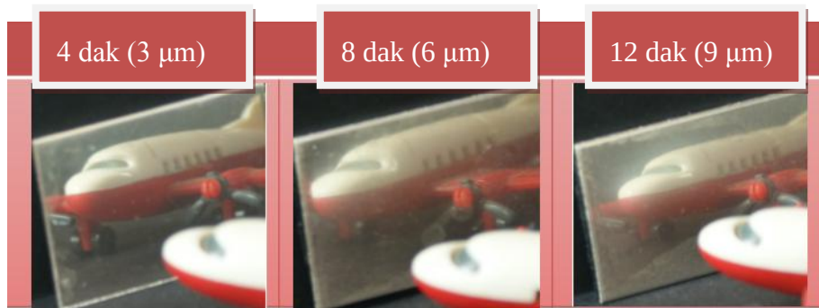
Şekil 8.27: Mercaptobenzothiazole (2 g/L) + KSeCN (3 ppm) banyosuyla yapılan kaplamalara zamanın etkisi.
