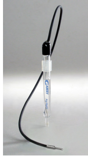
Şekil 2.31 : Vycor camından üretilmiş bir Ag-AgCl referans elektrotu
