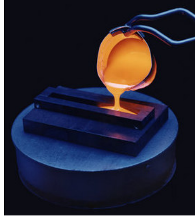
Şekil 2.35 : Bor silikat camının ergitilerek kalıba dökülmesi
