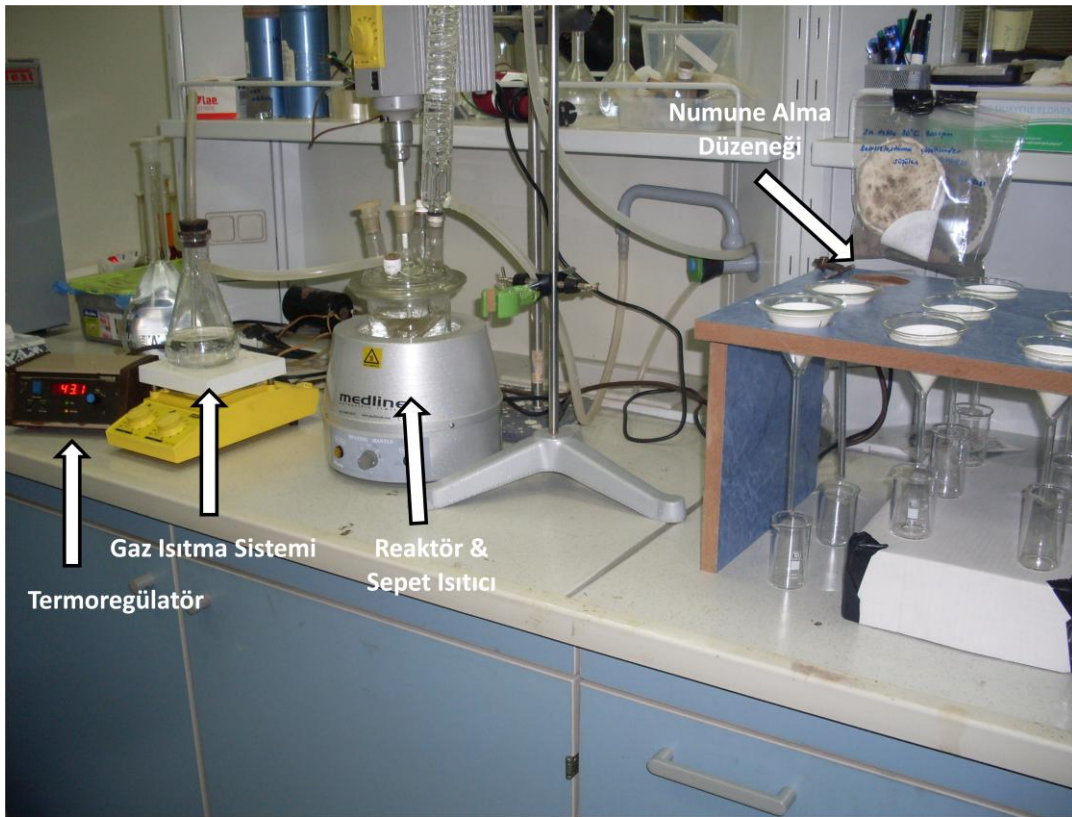
Şekil 6.6: Atmosferik koşullarda yapılan deneyler için deney düzeneği
