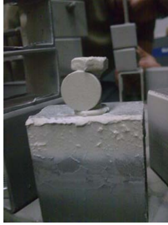
Şekil 4.10: Plazma uygulaması sonrası seramik kaplanmış numune
