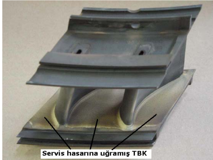
Şekil 2.4 : Servis hasarına uğramış 2. seviye sabit YBT kanatçığı [19].
