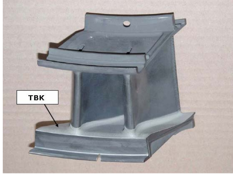
Şekil 2.3 : TBK uygulanmış 2.seviye sabit yüksek basınç türbin kanatçığı [19].
