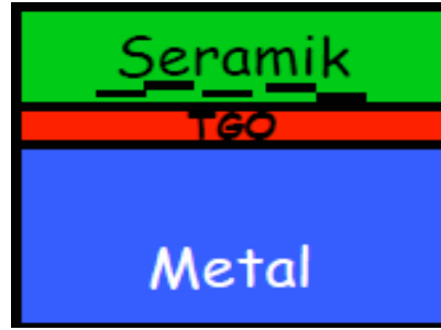
Şekil 3.7 : Başlangıç çatlaklarının oluşumu.
