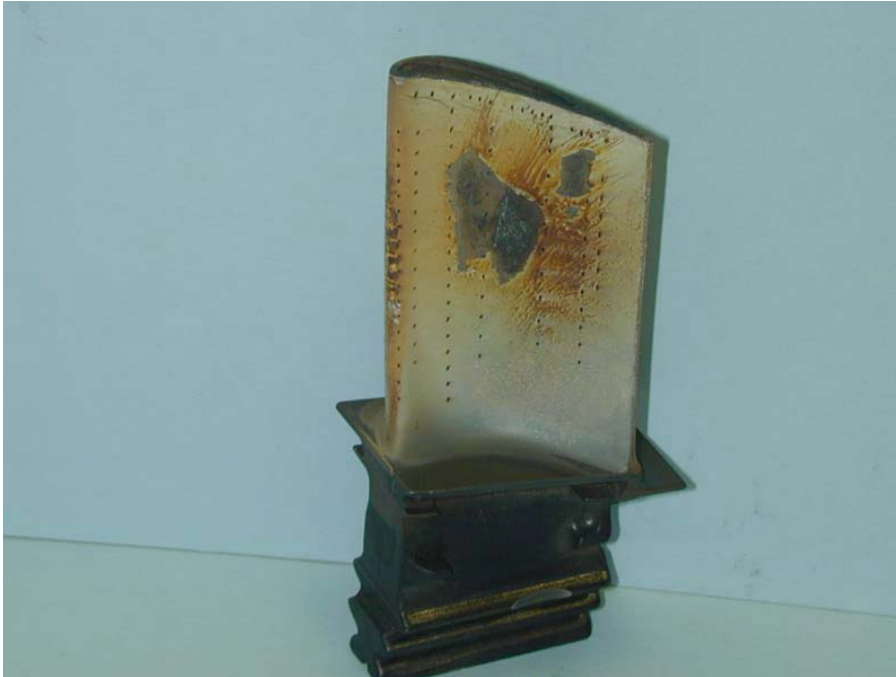
Yüksek basınç türbin palesinde oluşmuş tipik servis hasarı [19]
