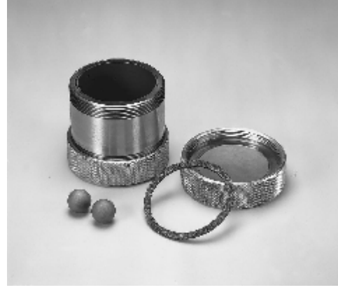
Şekil 3.2 : SPEX 8000 karıştırıcı/öğütücü ve WC kap ve bilyeler (Suryaranayana, 2001).
