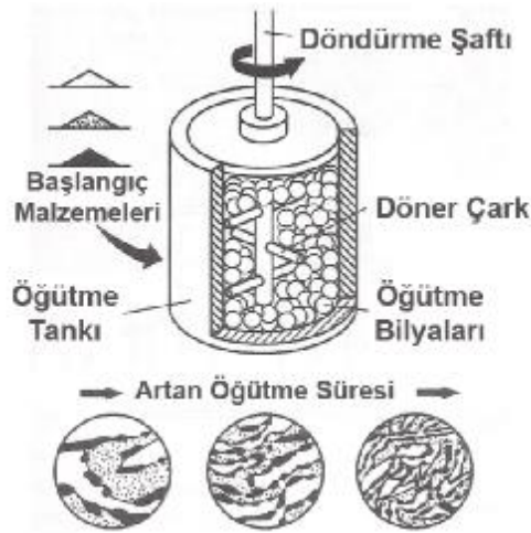
Şekil 3.3 : Atritörün şematik gösterimi (German, 1994).
