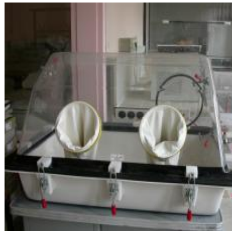
Şekil 6.1 : (a) SPEX™ yüksek enerjili bilyalı öğütücü, (b) Kapalı ortam kutusu.
