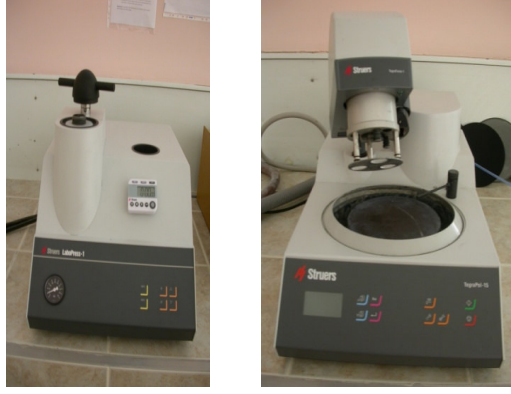
Şekil 3.10 : Struers marka bakalite alma ve parlatma cihazları.
