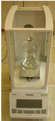
Şekil 3.12 : Preciso marka hassas terazi ve yoğunluk ölçüm aparatları.
