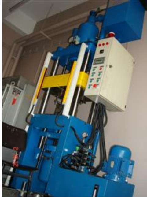
Şekil 3.7 : Tek yönlü soğuk pres ve ön şekillendirmede kullanılan kalıp.
