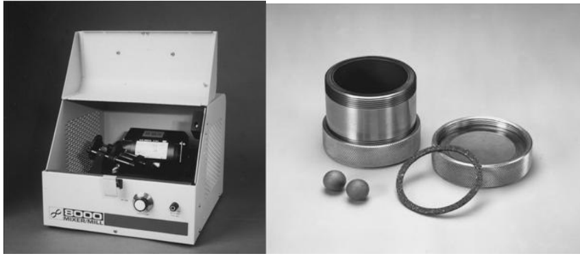
Şekil 3.1 : SPEX 8000 serisi karıştırıcı/öğütücü ile WC kap ve toplar.
