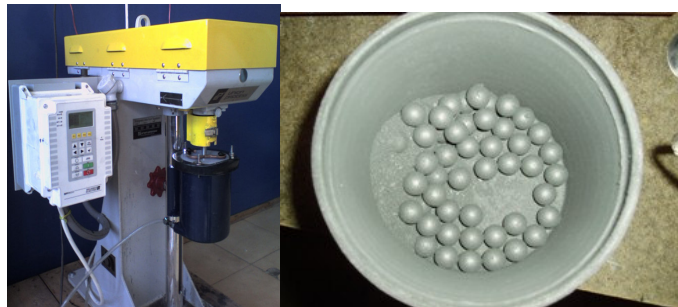
Şekil 3.5 : Union Process atritör ile karıştırma işleminde kullanılan kap ve toplar.
