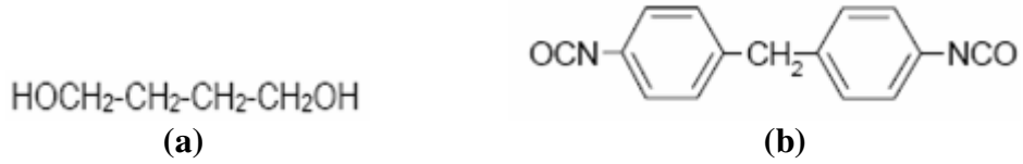
Şekil 3.1: (a) 1,4 Bütandiol, (b) Difenilmetan Diizosiyanatın Kimyasal Yapısı
