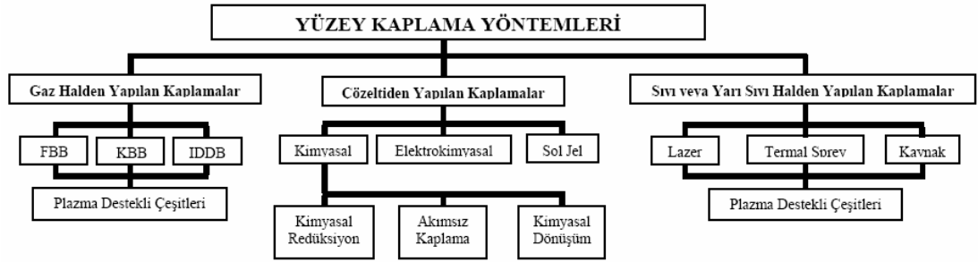
Şekil 3.1: Çeşitli Yüzey Kaplama Yöntemlerinin Genel Sınıflandırılması [17]
