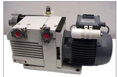
Şekil 3.3: Mekanik Pompa ve Çalışma Prensibi [20,21]
