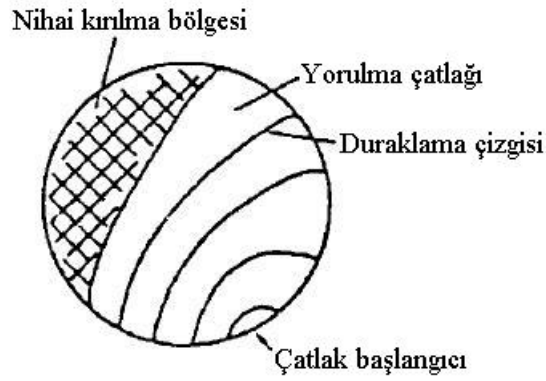
Şekil 5.7 : Yorulma kırılmasının şematik olarak gösterimi [21].
