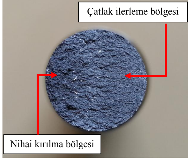
Şekil 7.8 : EN-GJS-600-3 numunesine ait yorulma kırılması yüzeyi ( \sigma = 350 MPa, N_f = 212658 ).
