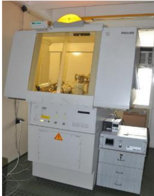
Şekil 4.5 : Philips PW-3710 model XRD cihazı.
