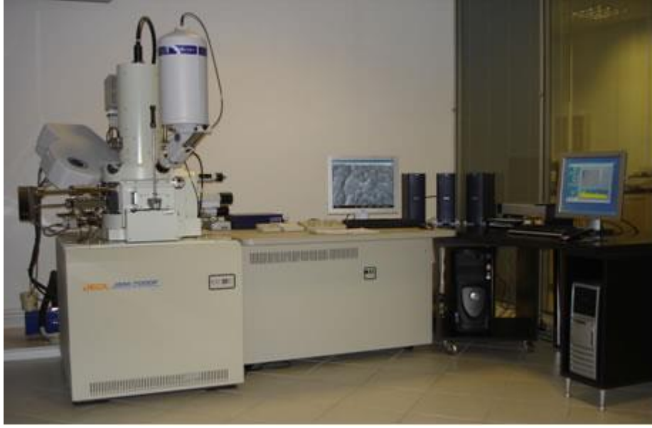
Şekil 4.10 : JEOL JSM-7000F marka tarama elektron mikroskobu (SEM).
