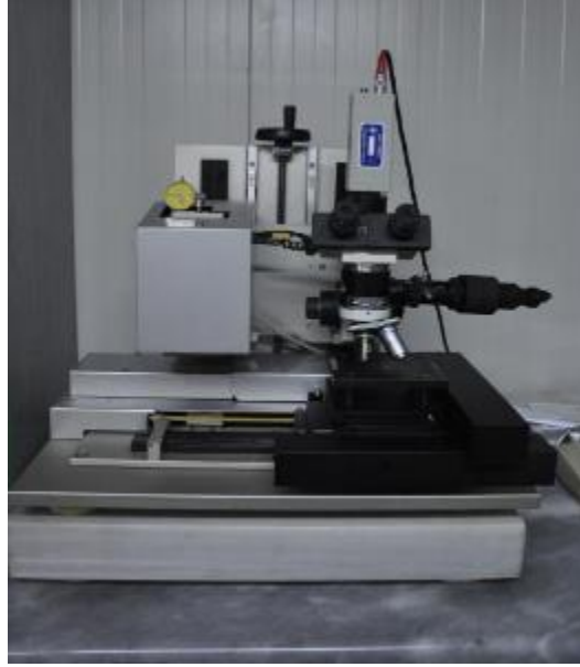
Şekil 4.12 : Fischer HP100 X-Y Prog model ultra mikro sertlik cihazı.
