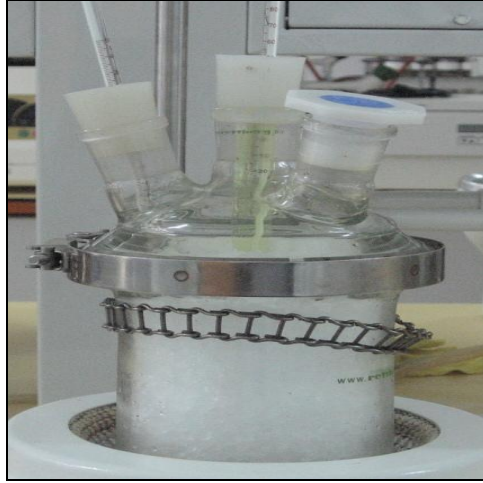
Şekil 3.12: Deneysel çalışmada kullanılan bulutlanma noktası tayin düzeneği.
