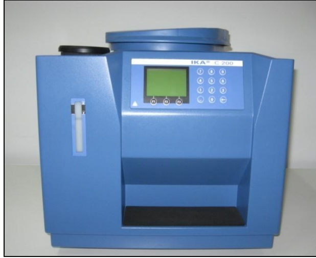
Şekil 3.10: Deneysel çalışmada kullanılan kalorimetre bombası.
