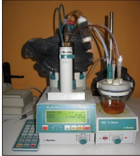
Şekil 3.13: Deneysel çalışmada kullanılan Karl Fischer nem tayin cihazı.
