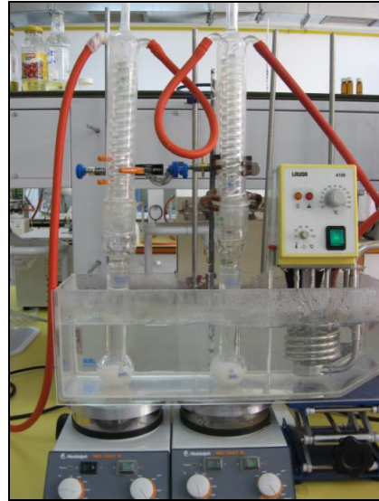
Şekil 3.7: Geleneksel ısıtma ile enzim katalizörü varlığında biyodizel üretimi.
