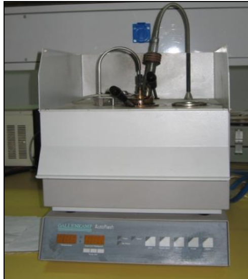
Şekil 3.11: Deneysel çalışmada kullanılan parlama noktası tayin cihazı.
