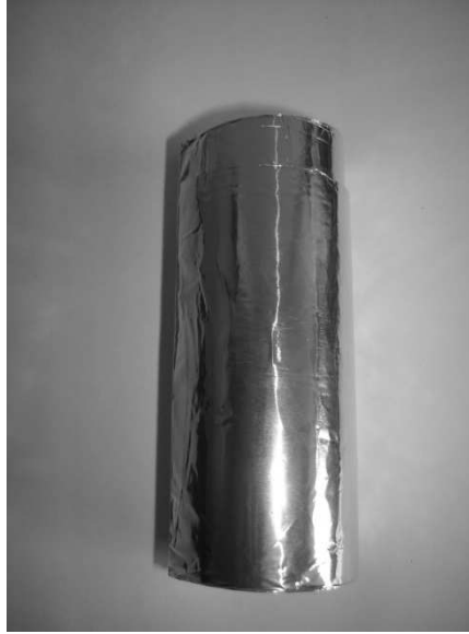
Şekil 3.6: Karbon Köpüğün Üretildiği Alüminyum Kap
