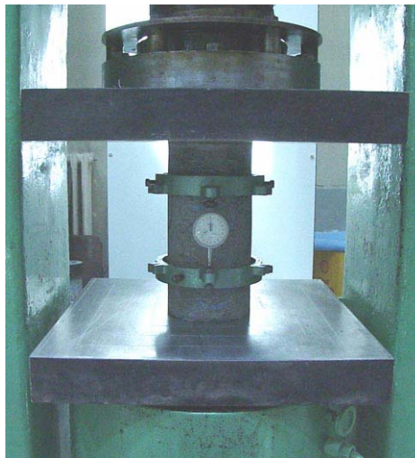
Şekil 3.1: Silindir basınç dayanımı ve eksenel şekil değiştirme deney düzeneği
