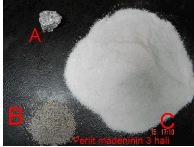
Şekil 2.1: Kayaç haldeki perlit (A), ham perlit (B) ve genişletilmiş perlitin (C) görünümü [6].
