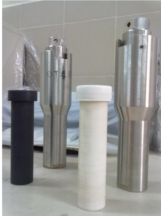
Şekil 2.2 Hidrotermal sentezin gerçekleştirildiği otoklavlar.
