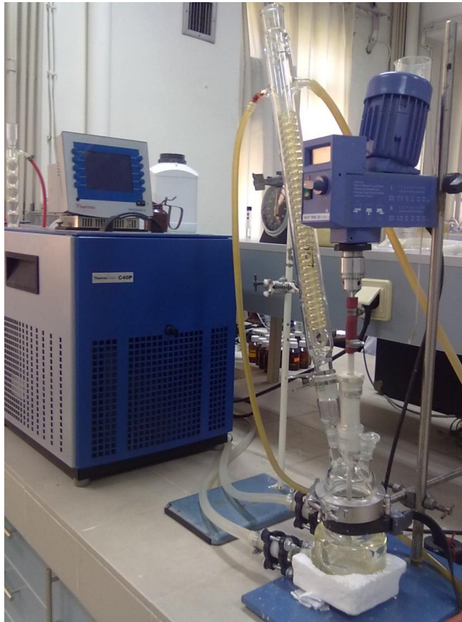
Şekil 2.1 Tek adımda çöktürme yönteminde kullanılan deney sistemi.
