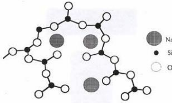
Şekil 2.3 : Alkali silikat camın atom yapısı [3].
