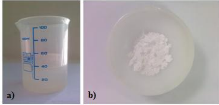
Şekil 5.2 : (a) Etüvde bekledikten sonra jelleşen sol-jel çözeltisi, (b) Jellerin ısıtılma işlemine tabi tutulmasıyla elde edilen sol-jel esaslı stronsiyum katkılı biyoaktif cam numunesi.
