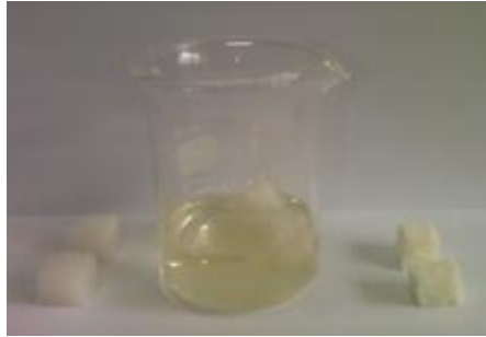
Şekil 5.4 : Yapı iskelelerinin jelatin çözeltisinde bekletilmesiyle elde edilen biyoaktif cam/polimer kompozit yapı iskeleleri.
