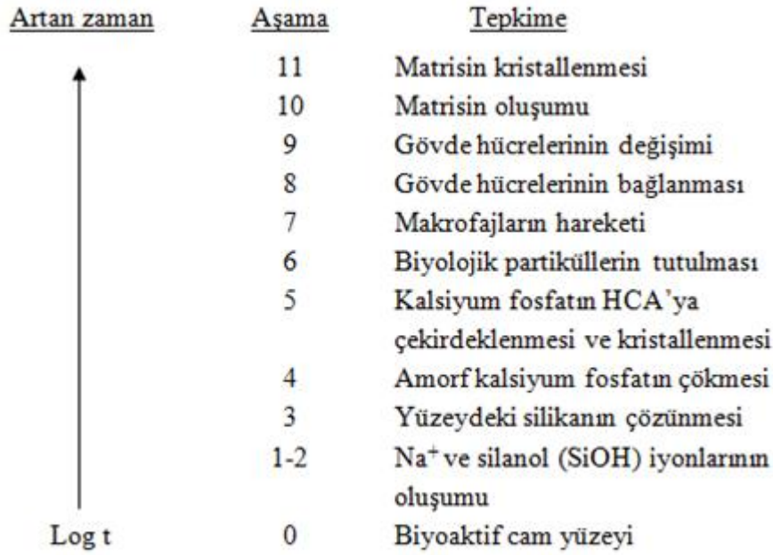
Şekil 2.4 : Biyocam ® yüzeyinde gerçekleşen tepkimelerin aşamaları [29].
