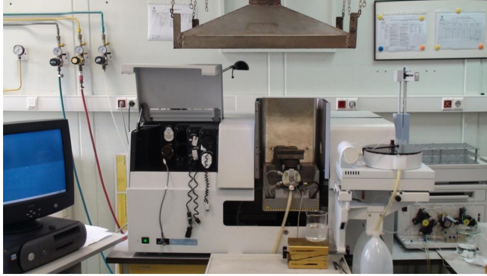
Şekil 5.4: Atomik Absorpsiyon Spektrometre (AAS Perkin Elmer Analyst 800).
