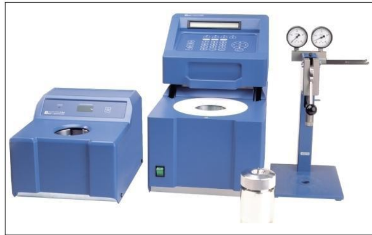
Şekil 5.1: Isıl değer analizinde kullanılan kalorimetre cihazı.
