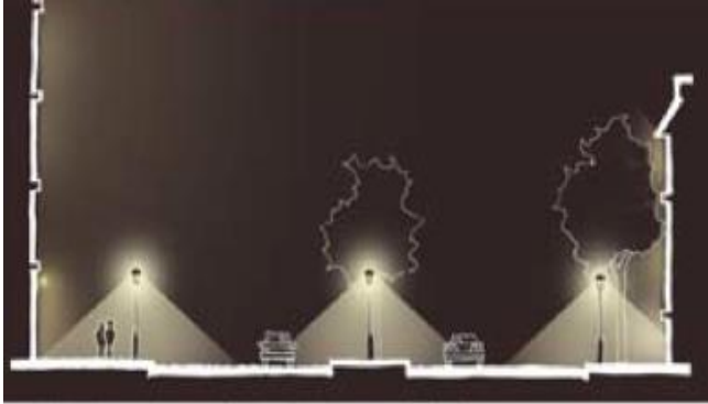
Şekil 4.31 : Yaya yolları aydınlatma tasarımı (sol), ana caddeler aydınlatma tasarımı, (sağ). (Kaynak:
