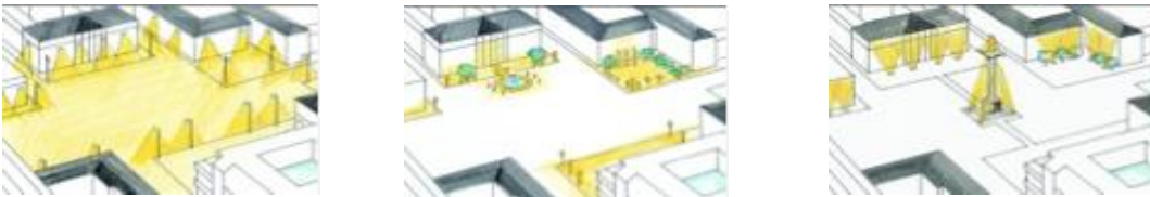
Şekil 4.32 : Carpet of light (sol resim), light zones (orta resim), pools of light (sağ resim). (Kaynak: Light Zone City, Light Planning in the Urban Context, Christe von Santen, 2006.)
