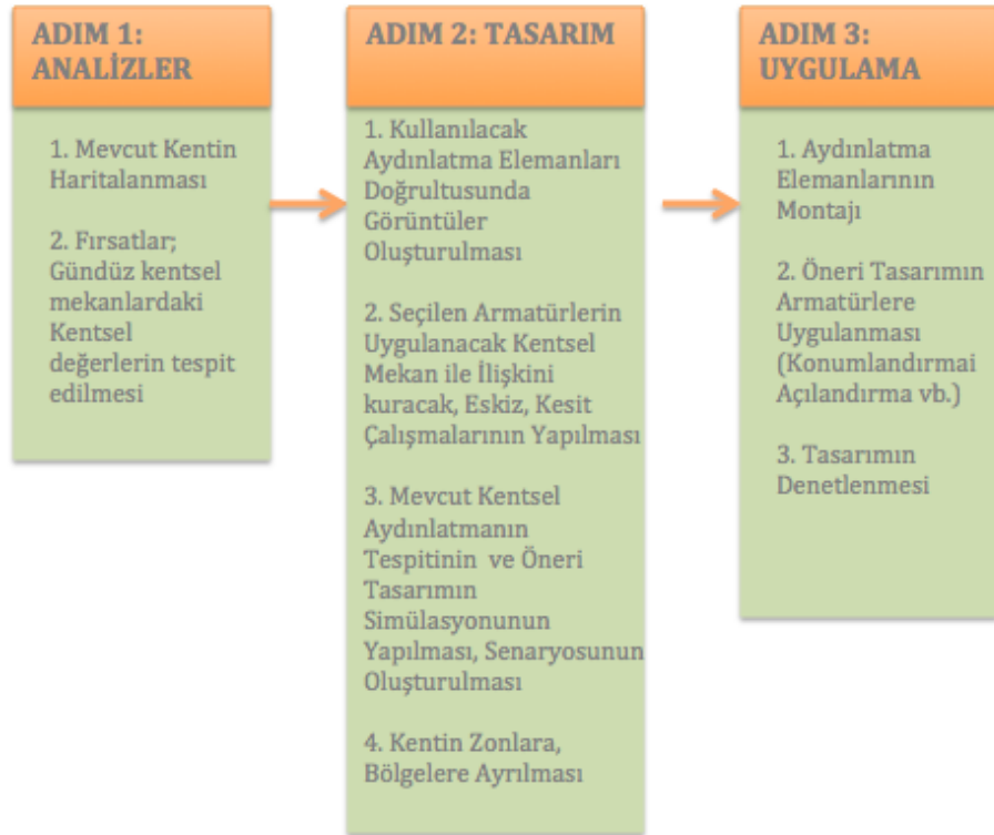
Şekil 4.3 : Aydınlatma master plan aşamaları. (Kaynak: See Philips, 2002; Lumsden, 1974)
