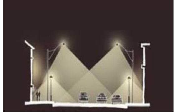
Şekil 4.31 : Yaya yolları aydınlatma tasarımı (sol), ana caddeler aydınlatma tasarımı, (sağ). (Kaynak:
