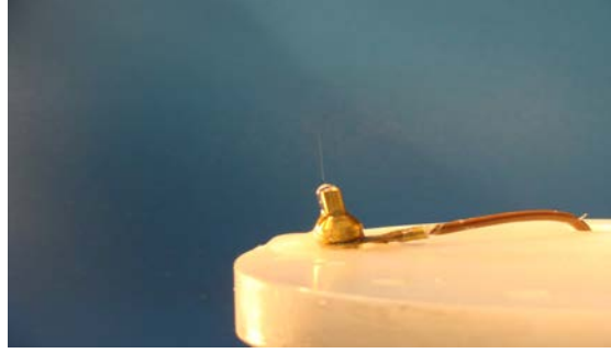
Şekil 3.1: Besleme Ucunda Meydana Gelen Taylor Konisinin Gösterimi
