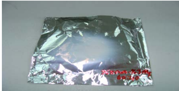
Şekil 3.2: Alüminyum Folyo Üzerinde Toplanan Nanolif
