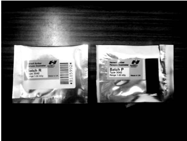
Şekil 1. 1. Harwell firmasının ürettiği Amber 3042 cinsi dozimetreler.
