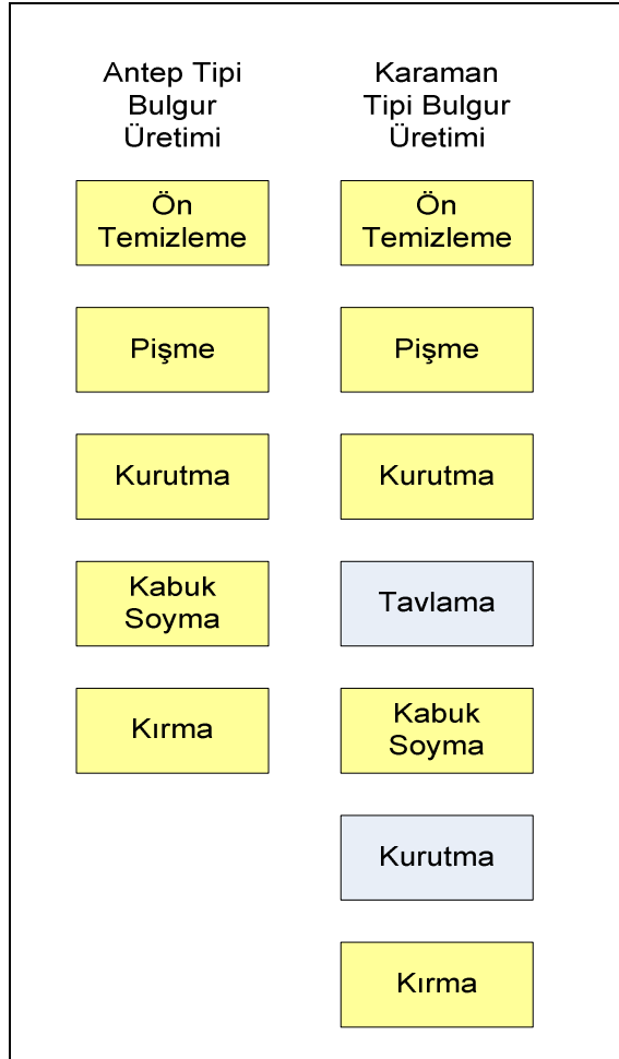
Şekil 2.1: Antep ve Karaman Tipi Bulgur Üretimlerine Ait Akım Şemaları
