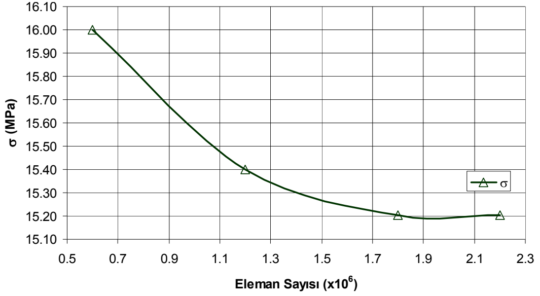
Şekil 3.7 : Dil kesitindeki gerilmenin eleman sayısına bağlı değişimi.
