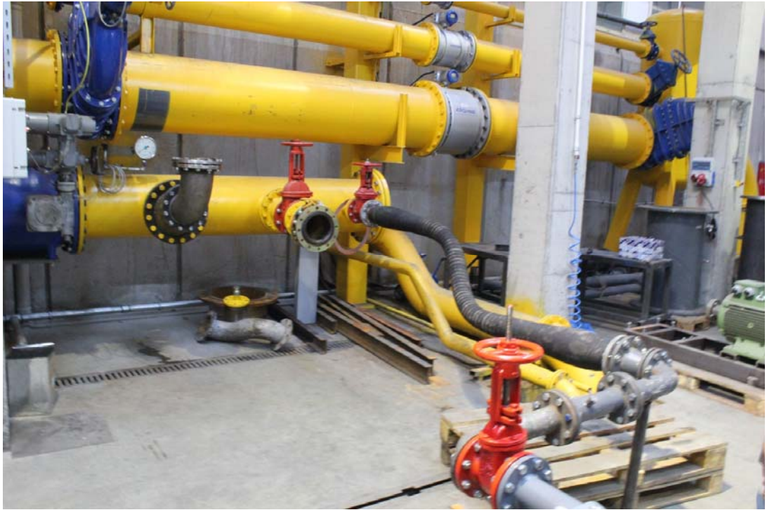
Şekil A.1 : Pompa deney düzeneği.
