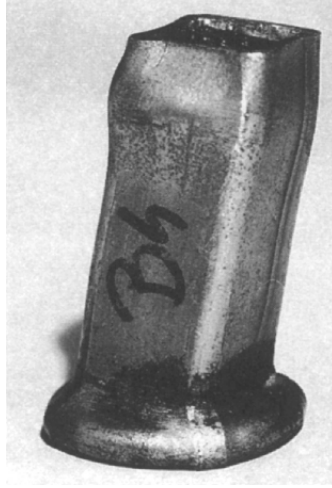
Şekil 3.16 : Dinamik eksenel yükleme durumunda deformasyona uğrayan ince cidarlı kare kesitli elaman için yayılma burkulma modu [54].
