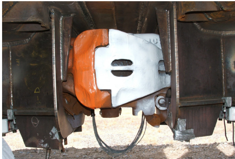
Şekil 2.2 : Geri itme koşum takımının çarpışmadan sonraki hali [16].
