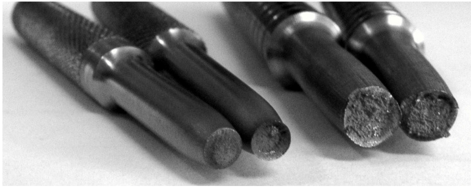
Şekil 1.1 : Sünek ve gevrek kırılmaya örnek (Koçak, 2003).
