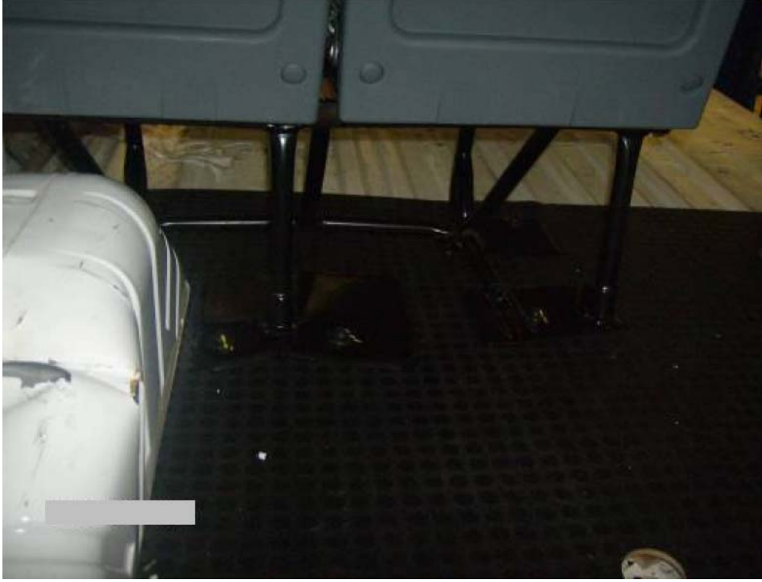
Şekil 4.19: 4. Sıra taban bağlantısı test sonrası görünüm.
