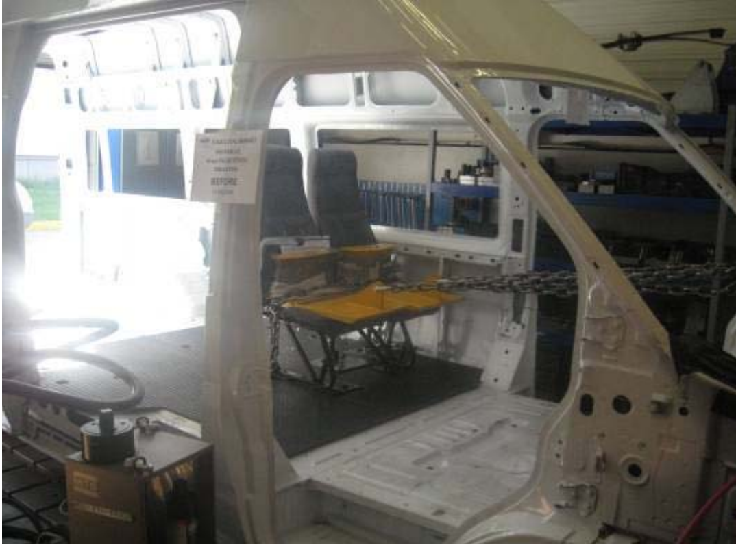
Şekil 4.15: Çekme testi düzeneği.
