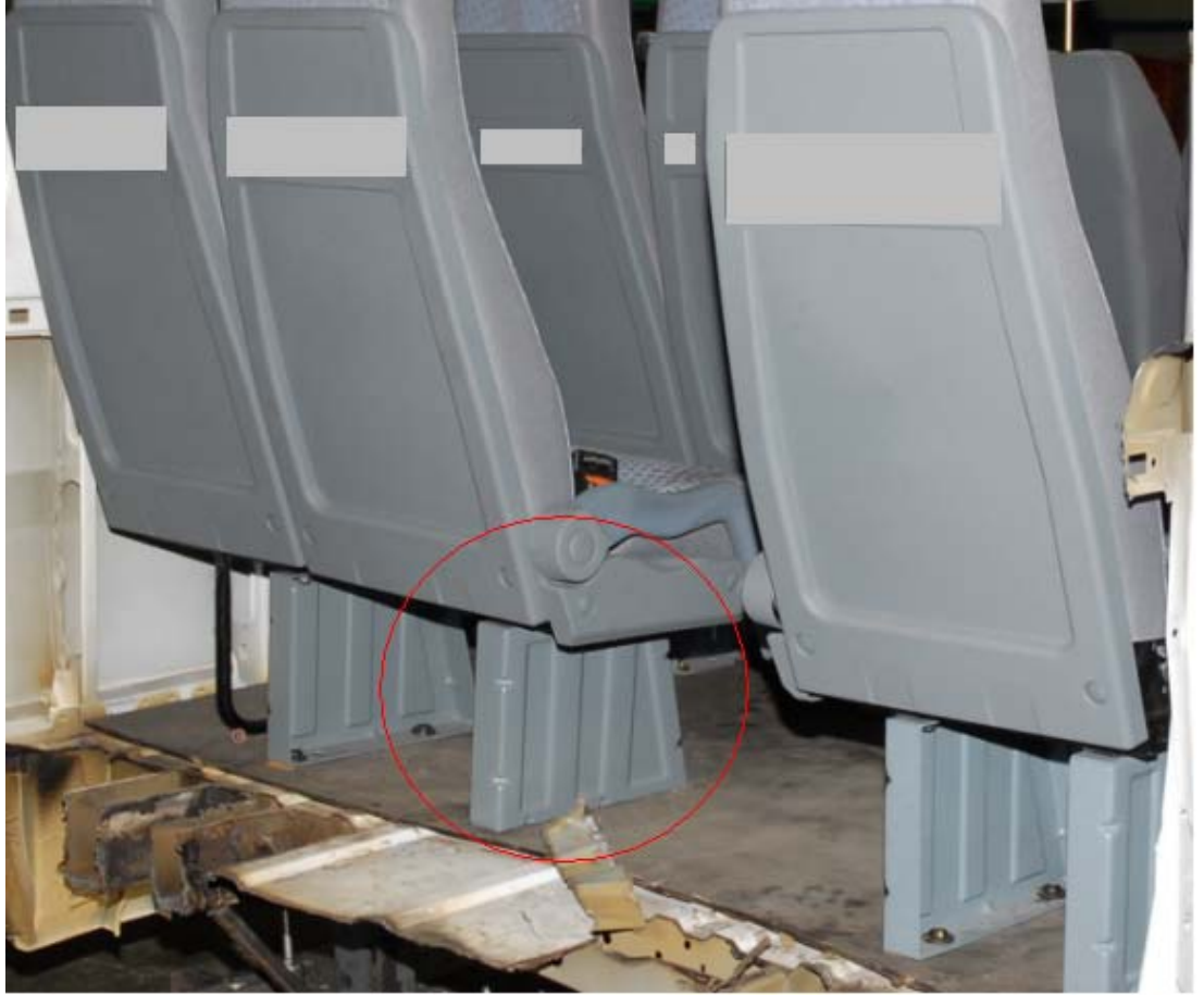
Şekil 3.7: Yeni regülasyonu sağlamayan mevcut koltuk bağlantısı.
