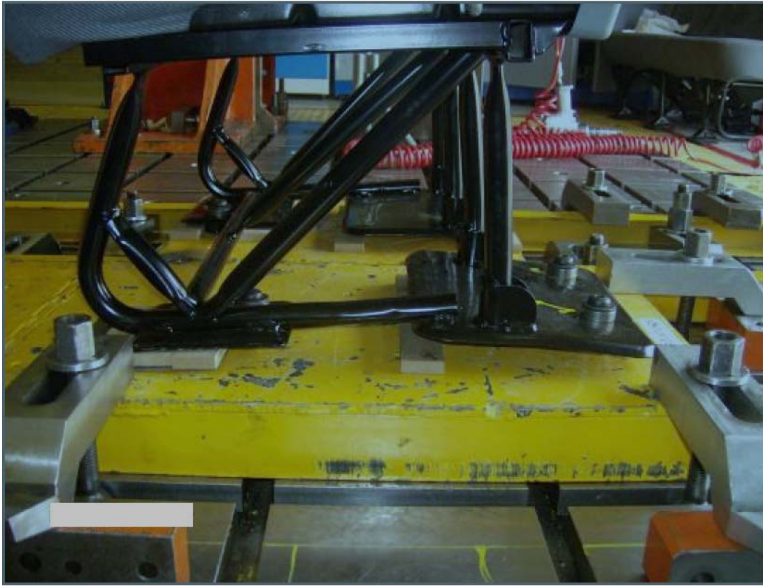
Şekil 4.23: 5. sıra test sonrası bağlantı durumu.
