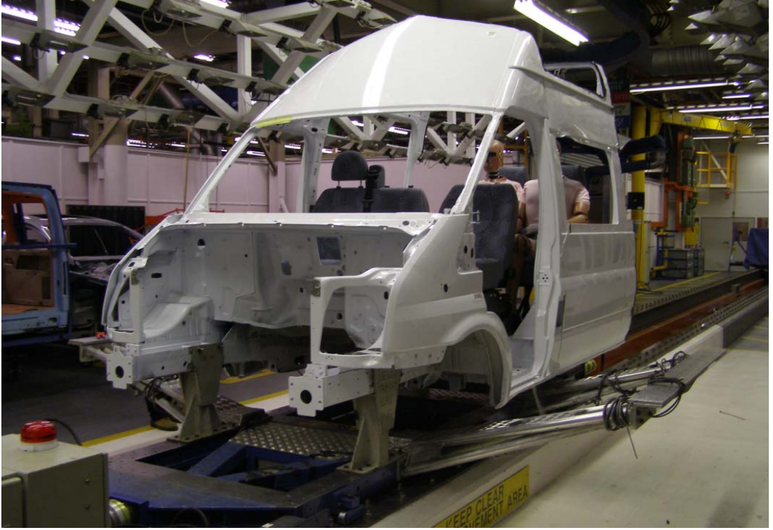
Şekil 5.2: Ön çarpışma test düzeneği.
