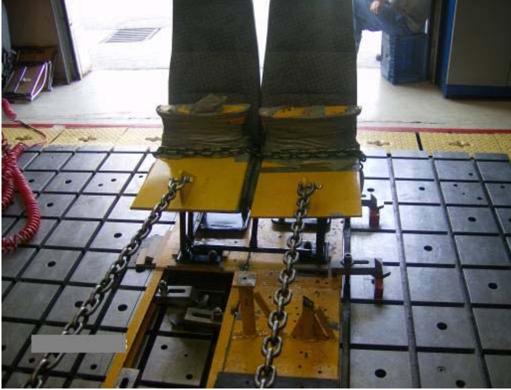
Şekil 4.22: 5. sıra ikili koltuk çekme testi düzeneği.
