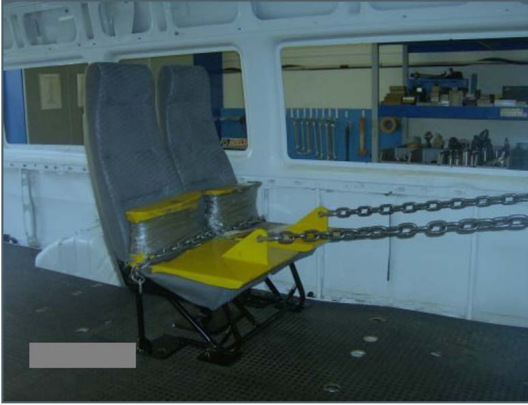
Şekil 4.17: 3. Sıra ikili koltuk çekme test düzeneği.
