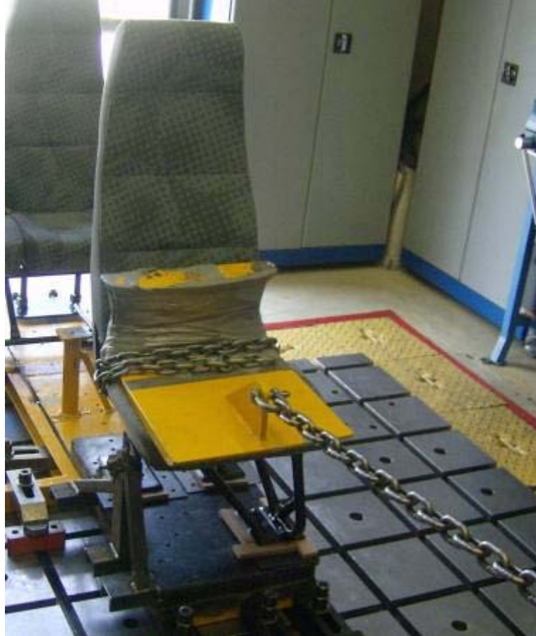
Şekil 4.21: 5. Sıra tekli koltuk çekme testi düzeneği.
