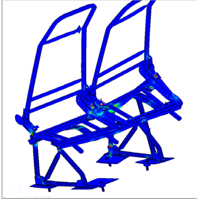
Şekil 4.1: Eski tasarımın 40 kph çarpma etkisi altındaki CAE analizi.
