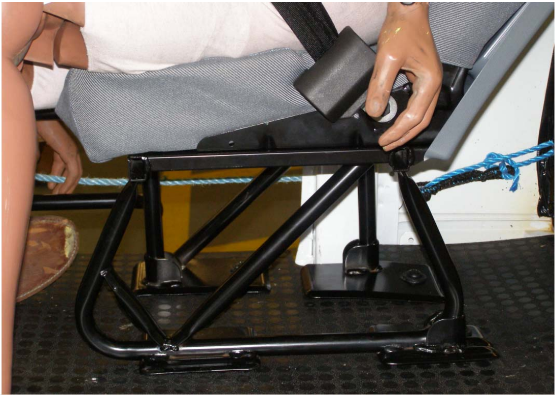
Şekil 4.11: Tekli Koltuk Çarpışma Testi Sonrası Görüntüsü.
