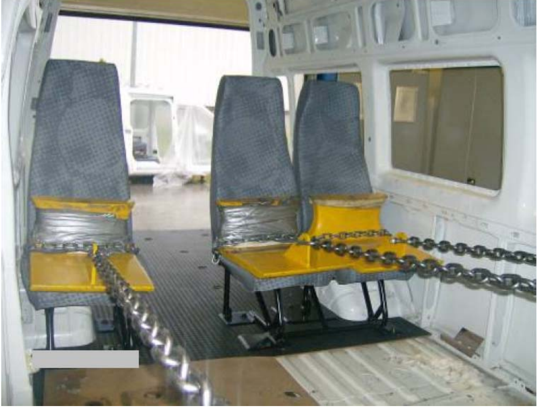
Şekil 4.18: 4. Sıra ikili ve tekli koltuk çekme testi düzeneği.
