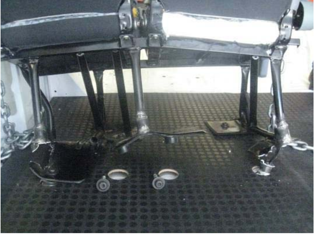
Şekil 4.16: Test sonunda koltuk bağlantısının durumu.
