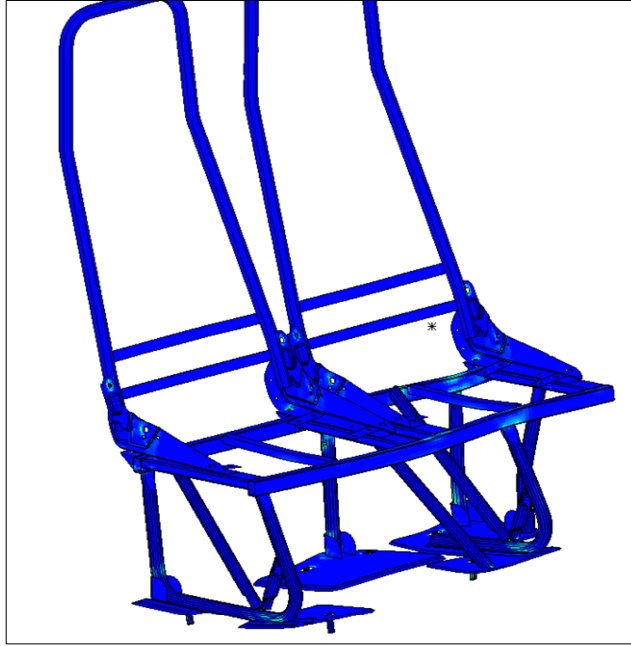
Şekil 4.2: Yeni tasarımın 40 kph çarpma etkisi altındaki CAE analizi.
