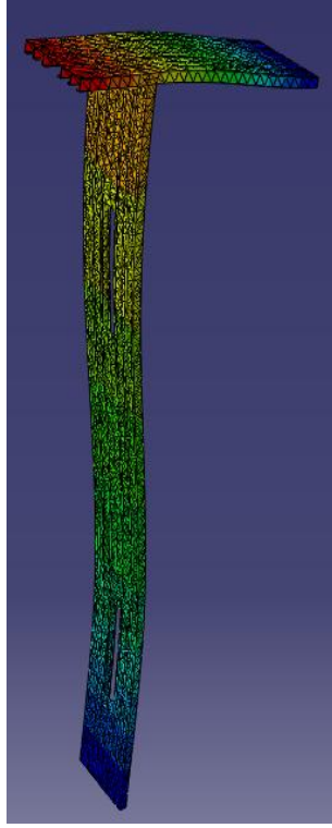
Şekil 3.75 : 90 Derece mod 4 ( f = 38,032 Hz).
