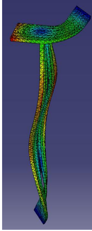
Şekil 3.79 : 90 Derece mod 8 ( f = 106,53 Hz).
