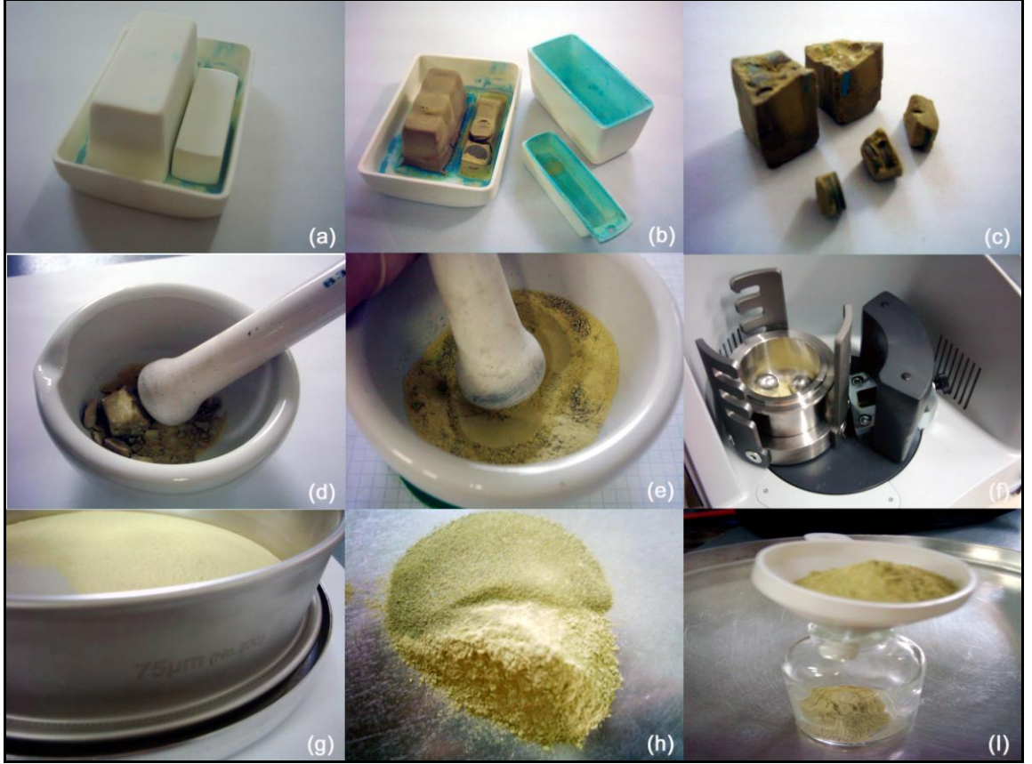
Şekil 6.1: PZT Tozunun Hazırlanması (a-c) Sinterlenen Tozlar (d-e) Öğütme İşlemi (f-i) Eleme ve Saklama
