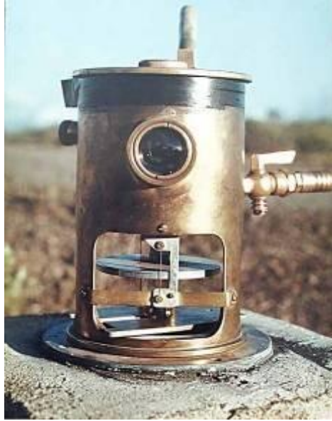
Şekil 2.13 : Mauna Loa Volkanı'nda bulunan tiltmetre (Url-2).
