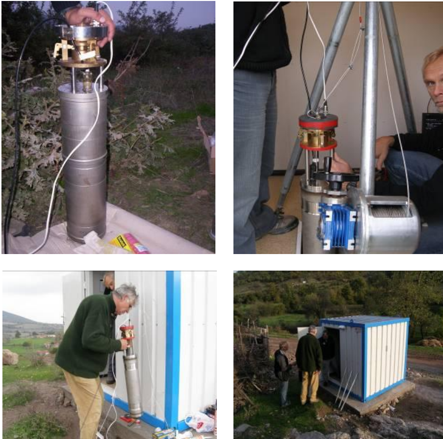
Şekil 4.10 : İstasyona tiltmetre sisteminin yerleştirilmesi.
