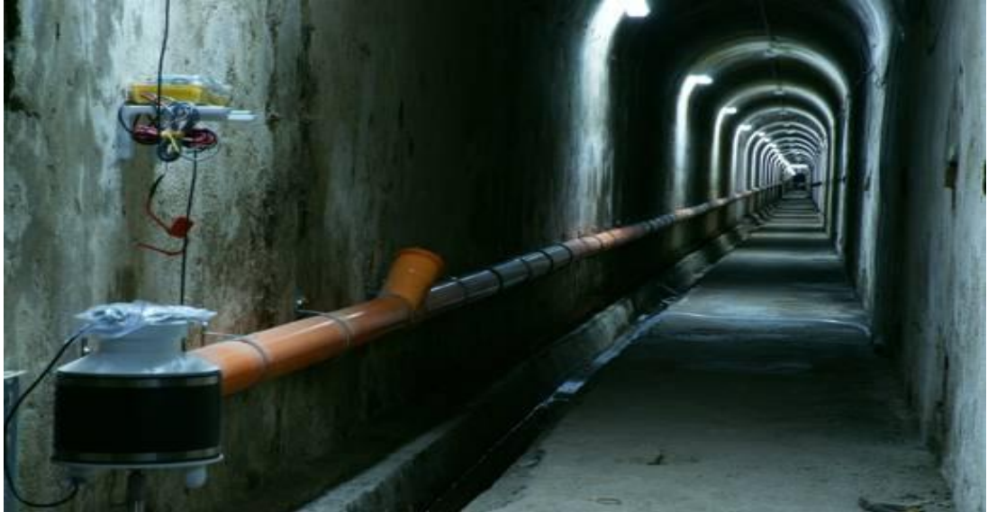
Şekil 2.15 : 241 metre uzunluğundaki su tüplü tiltmetre, Pozzuoli-İtalya (Url-3).
