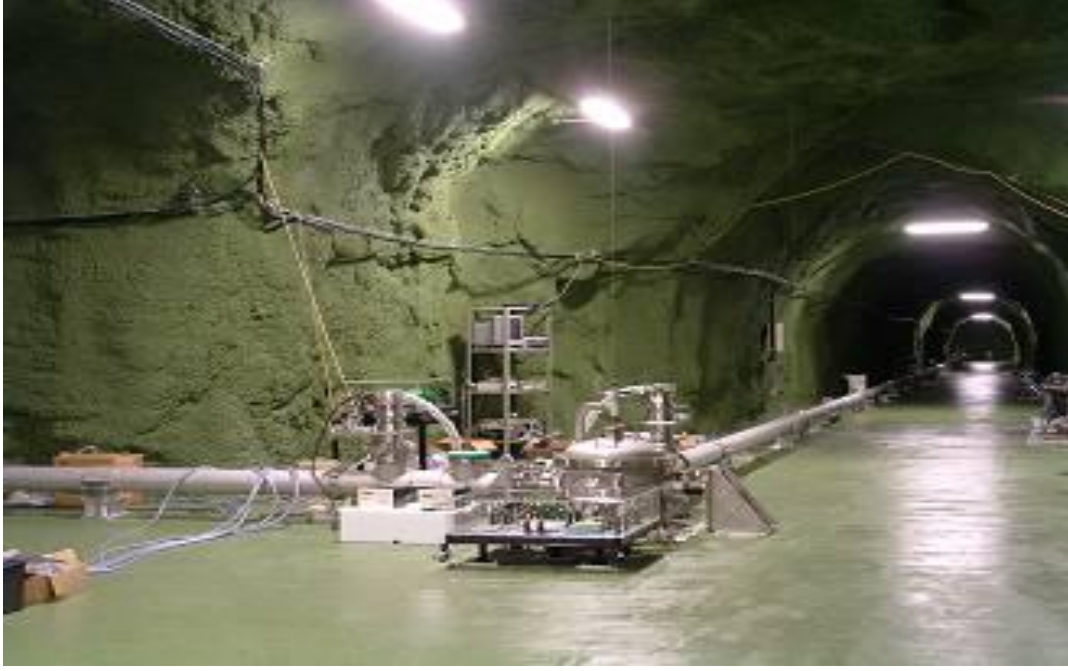
Şekil 2.17 : Japonya Kamioka Gözlemevi'ndeki lazer strainmetre (Url-4).
