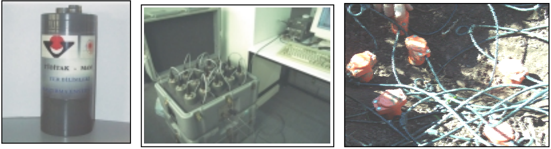
Şekil 3.1 Reftek-125 kayıtçısının, gerekli donanımın ve jeofonların fotoğrafları.
