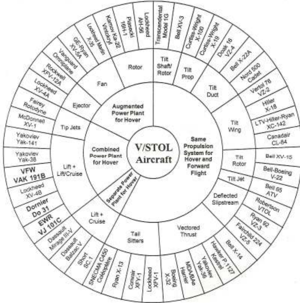
Şekil 1.1 : DİK uçakları ve dikey iniş kalkış metotları [2].
