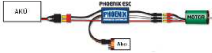
Şekil 4.1 : Elektronik hız kontrol ünitesi bağlantı şeması [36].
