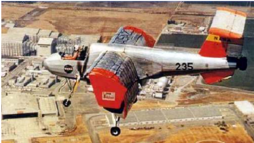
Şekil 1.4 : Deflected Slipstream metodu ile uçan NASA/Ryan VZ-3RY NASA/Ryan VZ-3RY Vertiplane [6].
