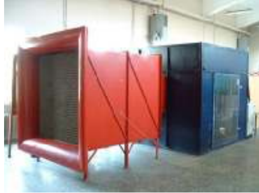
Şekil 4.2 : Eiffel tipi 80x80 açık deney odalı rüzgar tüneli [37].
