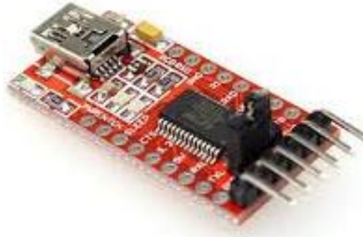
Şekil 4.2 : UART arayüzünden USB arayüzüne dönüşüm sağlayan FTDI dönüştürücü.
