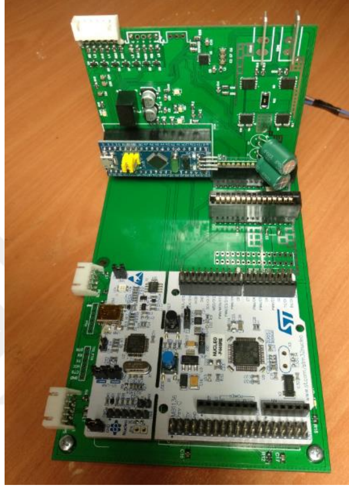
Şekil 2.44 : Üretilen anakart ve motor sürücünün bir aradaki görünümü.
