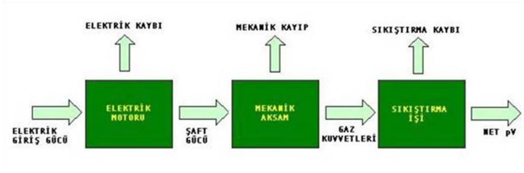
Şekil 3.2 : Kompresörde elektrik giriş gücünün dağılımı
