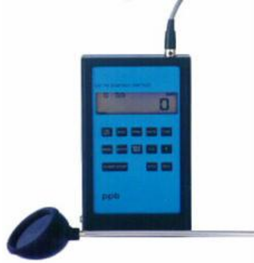
Şekil 6.1: Kavitasyon enerji ölçümünde kullanılan ultra/megasonik enerjimetre.
