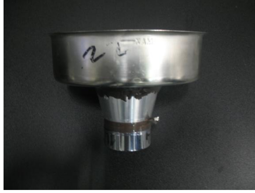
Şekil 6.2: Transduser tepkilerini ölçmek için kullanılan yıkama tankı.
