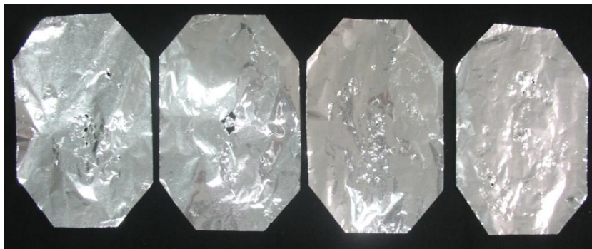
Şekil 5.2: 95W-47 kHz transduserin oluşturduğu kavitasyon altında sırasıyla 20, 40, 60 ve 180 sn. boyunca bekletilen alüminyum folyo örnekleri
