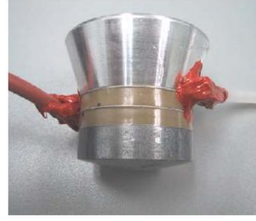
Şekil 2.4: Piezoelektrik transduser [URL-1]
