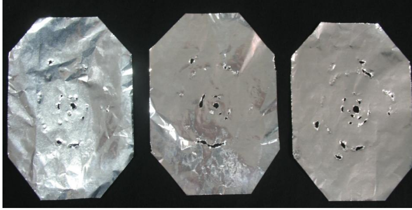
Şekil 5.1: 110W-28kHz transduserin oluşturduğu kavitasyon altında sırasıyla 20, 40 ve 60 sn. boyunca bekletilen alüminyum folyo örnekleri
