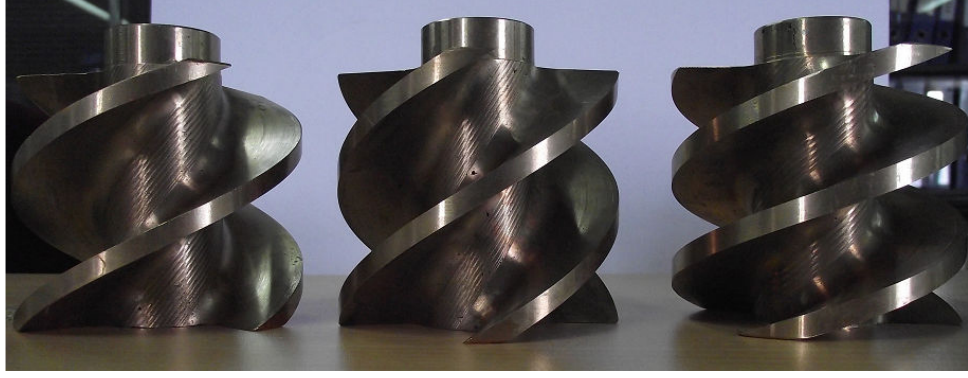
Şekil 4.14 : 25.5° 3 kanat, 30° 4 kanat ve 18° 3 kanatlı önçarklar (soldan sağa).
