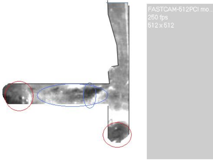
Şekil 5.46 : 141 kanalı için 13 mm/s giriş hızında ve r30n50 mıknatıs konumu için asıltıdaki taneciklere ait görüntü.
