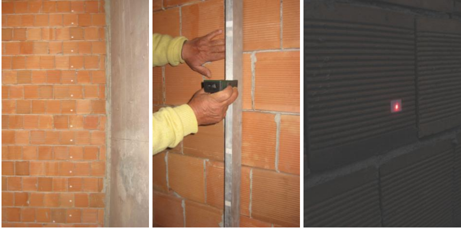
Şekil 5.3: Düşey hat üzerindeki 15 noktanın karşı duvardan dijital lazer ile ölçümü.
